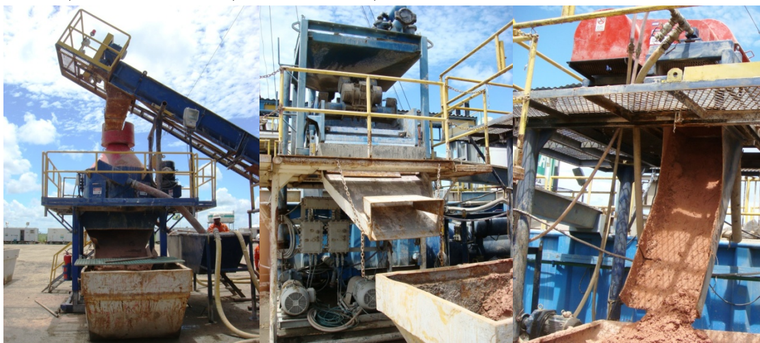
FIGURA 10 SISTEMA DE RECUPERAÇÃO DE FLUIDO DE PERFURAÇÃO, UTILIZADO PELA SONDA SC-82, NO POÇO DE PROSPECÇÃO 7-SMC 50-D AL, NA CIDADE DE SÃO MIGUEL DOS CAMPOS. A ESQ. SECADOR VERTICAL VORTEX. CENTRO MUD CLEANER E À DIREITA A CENTRIFUGA DE DUPLA FUNÇÃO
