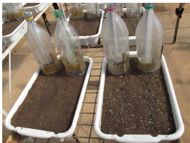
FIGURA 7 ESTUDOS VOLATILIZAÇÃO DE N DAS MISTURAS PASTILHADAS DE UREIA COM DIFERENTES FONTES DE ENXOFRE. 2010-2012.
